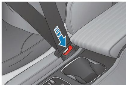
4. シートベルトのアンカーアジャスター（前側）を調節して、適切な位置にします。
