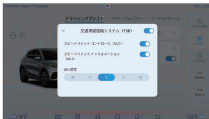
■ システムが道路の速度制限標識を認識できる場合に、メーターには認識された速度制限アイコンが表示されます（例：
